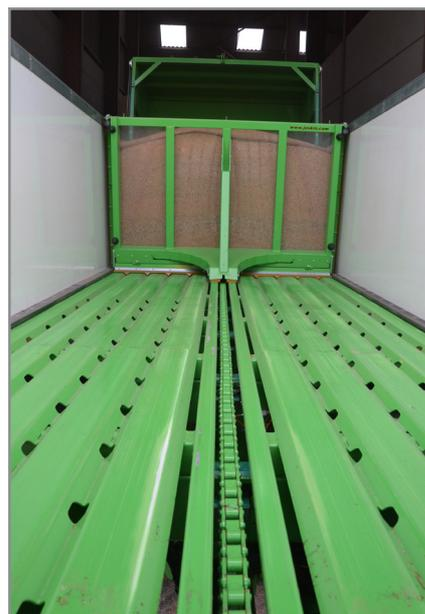
*DRAKKAR CATENA® : au déchargement, la chaîne d'assistance double la force de transport de la charge sur laquelle la paroi en plexi offre une visibilité totale.*
